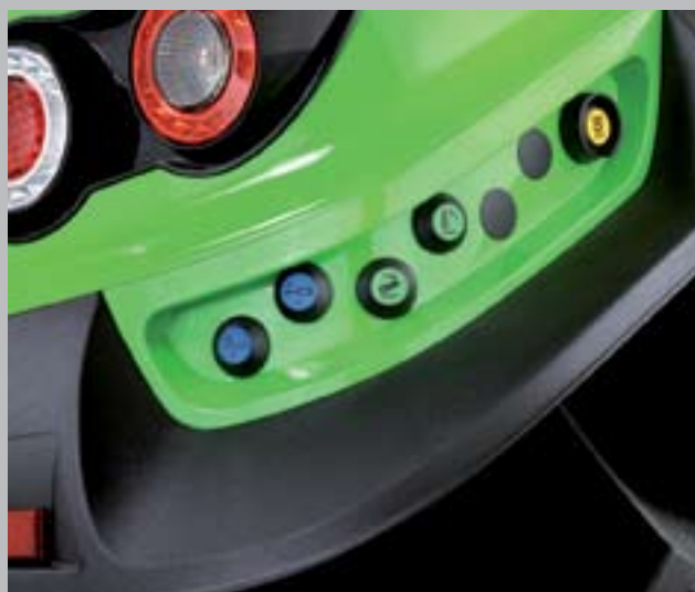
Εξωτερικά τηλεχειριστήρια για τα υδραυλικά, την πίσω ανύψωση και το PTO από κάθε πλευρά.
