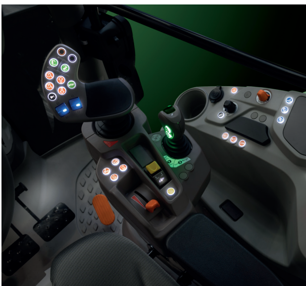
↑ Το καταξωμένο χειριστήριο MaxCom που εξοπλίζει τις εκδόσεις TTV είναι ένα συμπαγές πακέτο υψηλής τεχνολογίας που επιτρέπει στον οδηγό να ελέγχει όλες τις κύριες λειτουργίες του μηχανήματος με την πλήρη άνεση του ενός χεριού.
