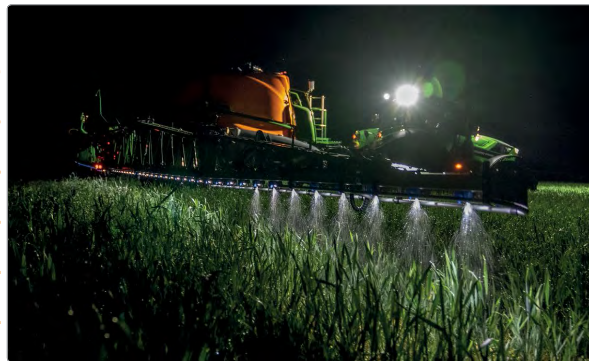
Με τον αυτόματο έλεγχο τμημάτων και ένα ψεκαστήρα με έλεγχο ενός ακροφυσιού, οι αγρότες και οι εξωτερικοί συνεργάτες εξοικονομούν πόρους, όπως τα χημικά προϊόντα φυτοπροστασίας. Ο αυτόματος έλεγχος τμημάτων με έως και 200 τμήματα ανήκει στο βασικό εξοπλισμό όλων των iMonitor.
