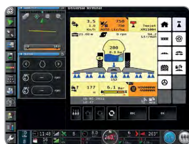
Ανεξάρτητα από το προφίλ εφαρμογής - όλα τα παρελκόμενα ISOBUS εμφανίζονται μέσω του γενικού τερματικού του iMonitor.
