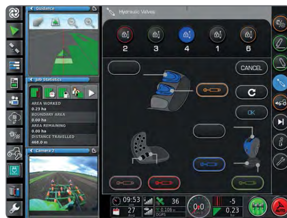
Υδραυλικές Βαλβίδες - Η σειρά των υδραυλικών βαλβίδων μπορεί να αλλάξει, καθώς και ο έλεγχος του ρυθμού ροής και του χρόνου.
