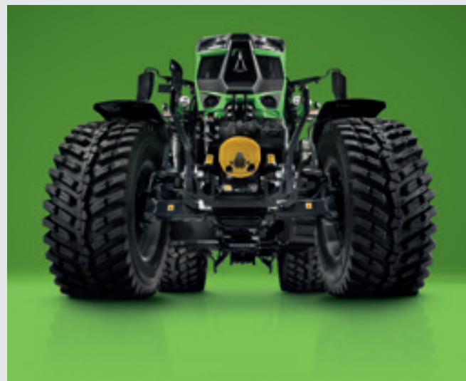
↑ Μπροστινή ζεύξη με ανυψωτική ικανότητα έως 5450 kg και προαιρετική μπροστινή λειτουργία ΡΤΟ DUALSPEED.
