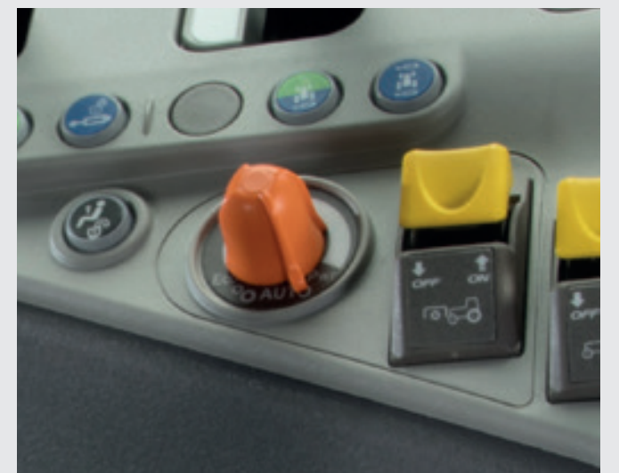
↑ Εύκολη και διασθητική λειτουργία: με τον διακόπτη ρύθμισης Eco/Power, ο χειριστής μπορεί να αλλάξει τη συμπεριφορά της αυτόματης αλλαγής ταχυτήτων APS (Automatic PowerShift).
