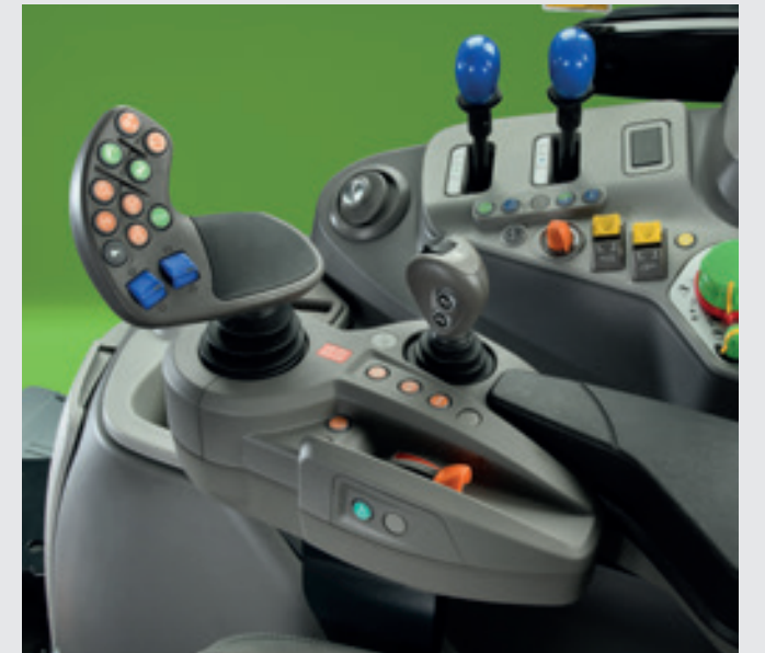
Η ροδέλα στο χειριστήριο MaxCom και οι δύο μηχανικοί μοχλοί ελέγχουν τις πίσω βαλβίδες, ενώ μπορείτε να χρησιμοποιήσετε το λεβιέ για να ελέγξετε τον εμπρόσθιο φορτωτή.
