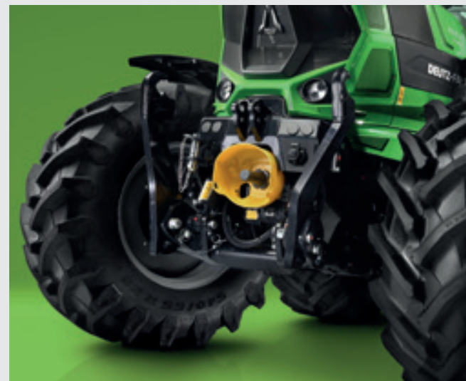
↑ Αποτελεσματικός μπροστινός ανυψωτήρας με ανυψωτική ικανότητα έως 3800 kg και προαιρετική μπροστινή λειτουργία ΡΤΟ 1000.
