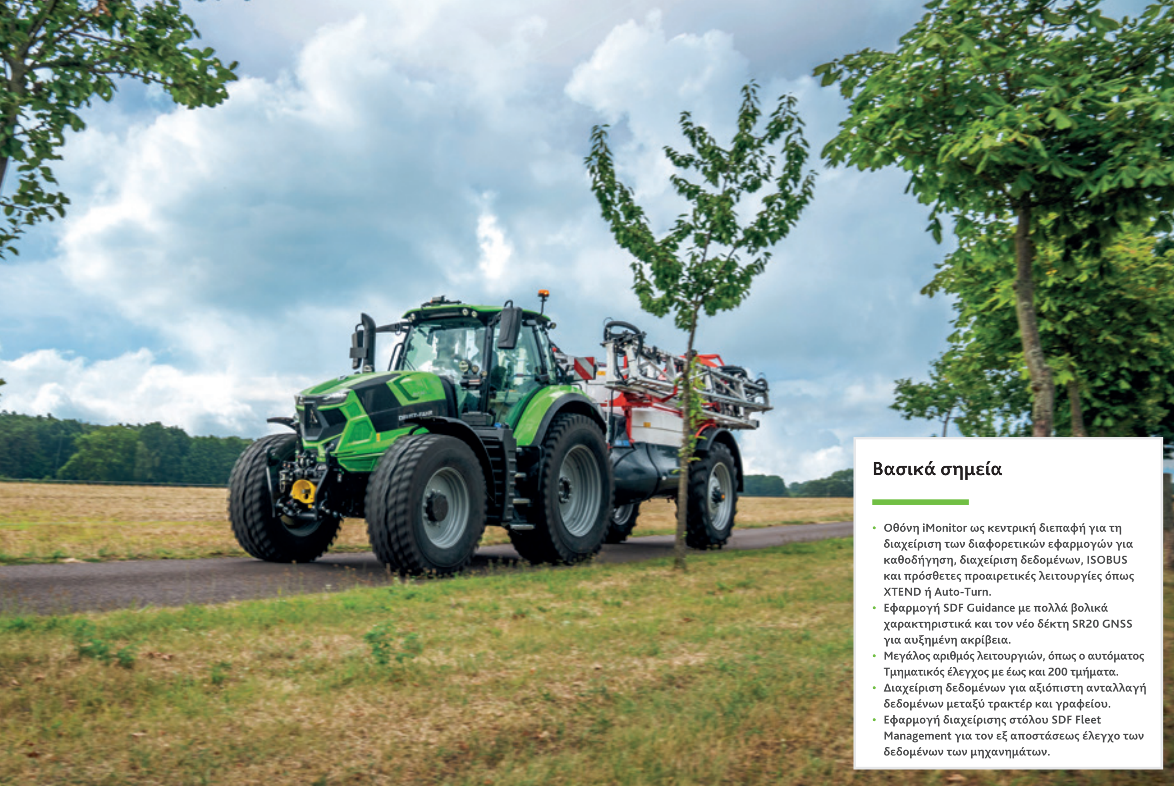
↑ Ο αυτόματος τμηματικός έλεγχος και ένας ψεκαστήρας με έλεγχο μεμονωμένων ακροφυσίων θα σώσουν τα φυτούγειονομικά στοιχεία. Ο αυτόματος τμηματικός έλεγχος με έως και 200 τμήματα διατίθεται από προεπιλογή ως λειτουργία στο iMonitor.
