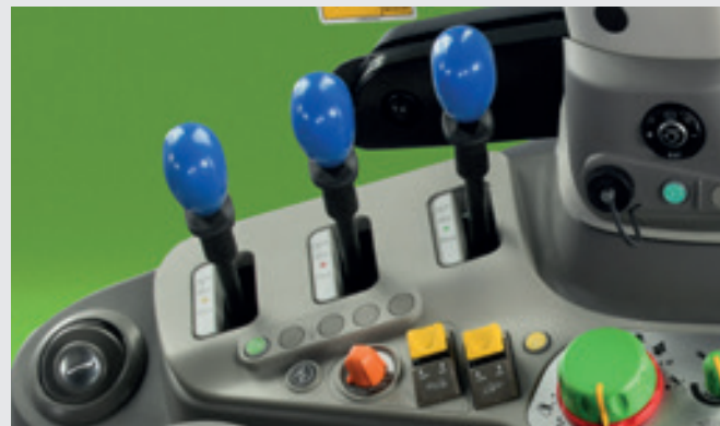
↑ Μέχρι 4 μηχανικές βαλβίδες στροφίων με εργονομικά στοιχεία ελέγχου σε έναν μοχλό.
