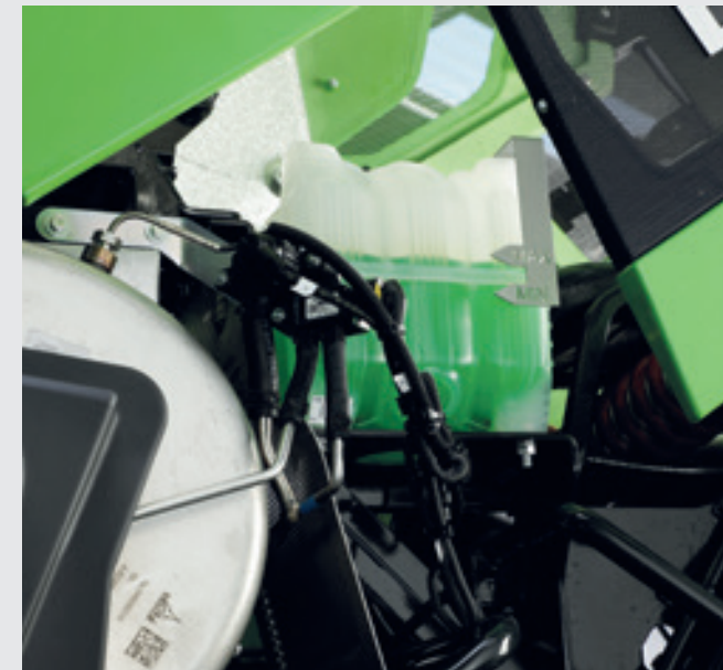
↑ Δεξαμενή νερού με δείκτη στάθμης από χάλυβα.
