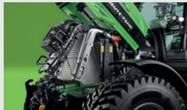
↑ Σύστημα ψύξης αλουμινίου για τα μοντέλα 6210 και 6230 με μοχλό πρόσβασης ενός χεριού και φίλτρο αέρα Powerscore με κυκλικό σύστημα προκαθαρισμού.
