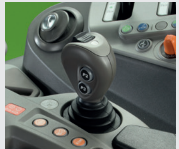
↑ Ιδανικό για εμπρόσθιο φορτωτή: Στο λεβιέ MaxiVision + θα βρείτε μια ροδέλα με δυνατότητα ρύθμισης, για αλλαγή κατεύθυνσης ή ενεργοποίηση της μετάδοσης κίνησης.
