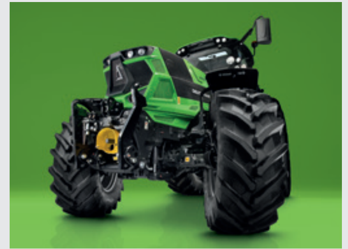
↑ Οι νέοι μπροστινοί άξονες επιτρέπουν υψηλότερα φορτία άξονα και ενσωματώνουν έναν νέο αισθητήρα ανάρτησης.
