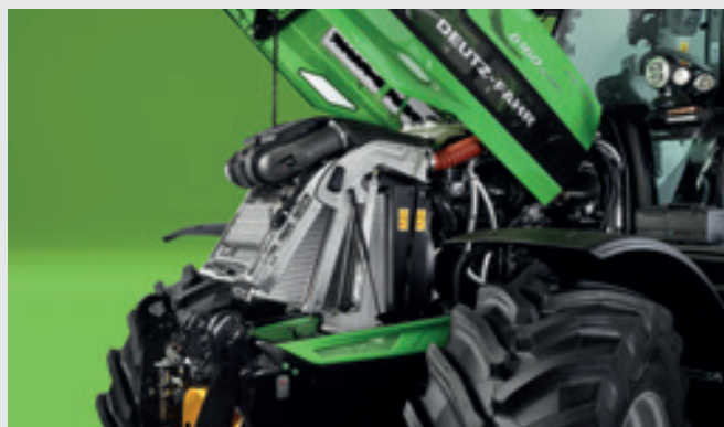
↑ Σύστημα ψύξης αλουμινίου για τα μοντέλα 6160.4 - 6190 με μοχλό πρόσβασης ενός χεριού και φίλτρο αέρα Powerscore με κυκλικό σύστημα προκαθαρισμού.
