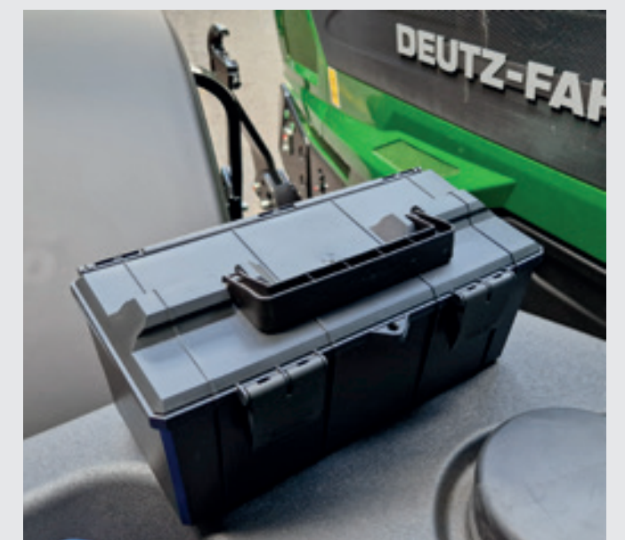
↑ Κιβώτιο αποθήκευσης επάνω από τη δεξαμενή καυσίμων στην αριστερή πλευρά για τον εύκαμπτο σωλήνα αέρα και το πιστόλι αέρα.
