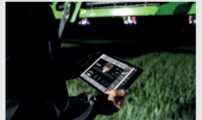
↑ Με το XTEND, είναι δυνατός ο έλεγχος των εργαλείων με ISOBUS UT ενώ βρίσκεστε εκτός της καμπίνας.
