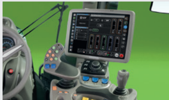
↑ Ηλεκτρικές βαλβίδες στροφίων με τα βολικά, ηλεκτρονικά στοιχεία ελέγχου.
