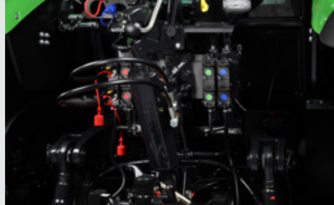
↑ Το υψηλό επίπεδο άνεσης συνδυάζεται με την εύκολη χρήση: Μικτή υδραυλική διαμόρφωση με δύο ηλεκτρικούς και δύο μηχανικούς διανομείς.
