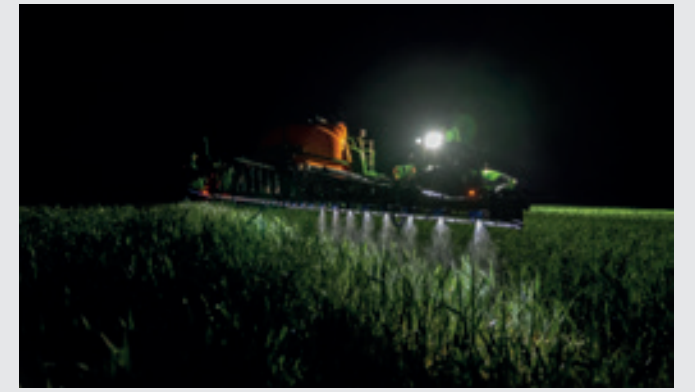
↑ Ο αυτόματος τμηματικός έλεγχος και ένας ψεκαστήρας με έλεγχο μεμονωμένων ακροφυσίων θα σώσουν τα φυτούγειονομικά στοιχεία. Ο αυτόματος τμηματικός έλεγχος με έως και 200 τμήματα διατίθεται από προεπιλογή ως λειτουργία στο iMonitor.
