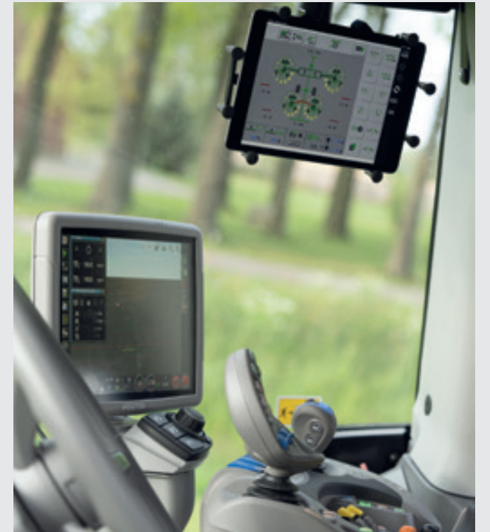
Η λειτουργία XTEND επιτρέπει την εμφάνιση της εφαρμογής SDF Guidance ή σας επιτρέπει να ελέγχετε τα εργαλεία με ISOBUS μέσω εξωτερικής συσκευής, π.χ. tablet.
