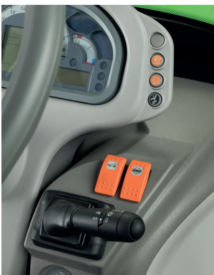
↑ Ηλεκτροδραυλική εμπλοκή για το και την ασφάλιση Διαφορικού.
