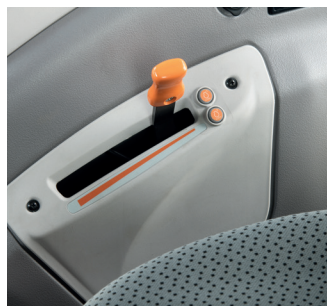
↑ Ηλεκτρονικό γκάτζι χειρός με δύο θέσεις μνήμης στροφών κινητήρα.
