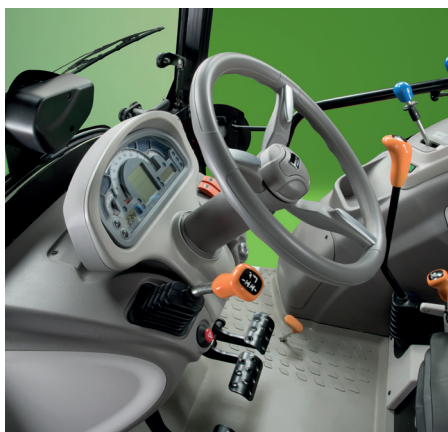
↑ Κιβώτιο πέντε ταχυτήτων με μηχανική αλλαγή σε όπισθεν στο ταμπλό.
