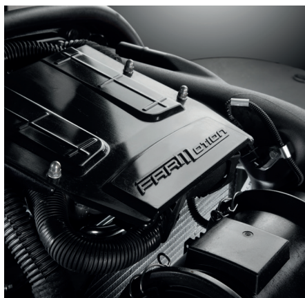
↑ Κινητήρες FARMotion 35 που συμμορφώνονται με την Φάση V, με έγχυση καυσίμου Common Rail και παροχή ισχύος έως 102 HP.
