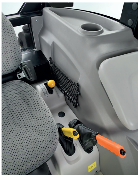
↑ Έως 3 ταχύτητες PTO με μηχανική εμπλοκή.
