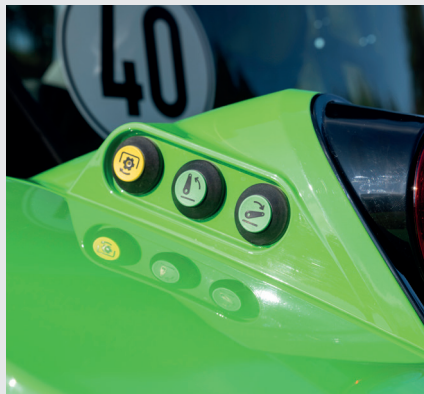
↑ Εξωτερικά χειριστήρια για πίσω ανύψωση και PTO.
