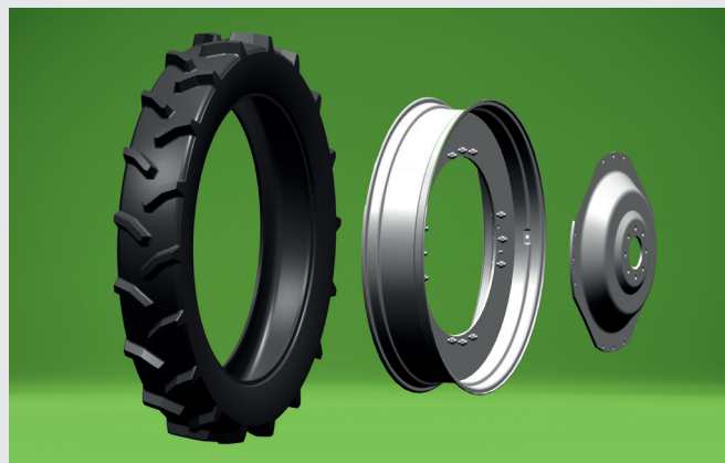
↑ Στενά ελαστικά για εφαρμογή σε καλλιέργειες σε σειρά.
