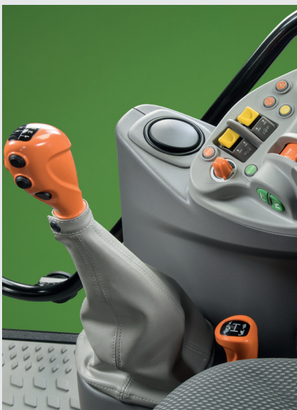
↑ Χειριστήρια κιβωτίου ταχυτήτων Powershift και διαχείριση APS.
